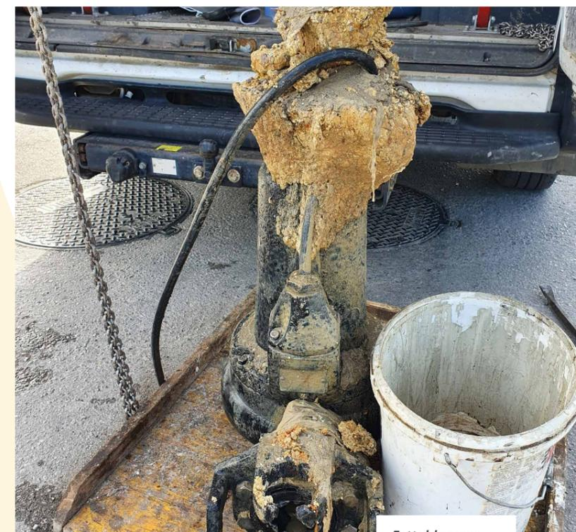
Fettablagerungen an der Abwasserpumpe.
